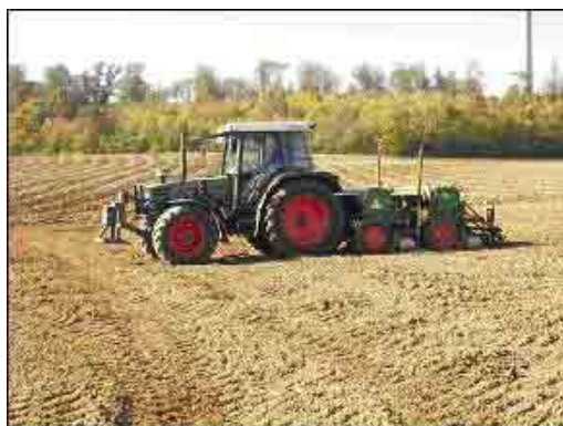
Bild 7: Zwei baugleiche mechanische Drillmaschinen für die Aussaat von Gemengen mit unterschiedlichen Verteilungsmustern (abwechselnde Reihen, Reihen-Streifen-Gemenge), unterstützt durch die Firma Amazone
