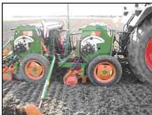
Bild 7: Zwei baugleiche mechanische Drillmaschinen für die Aussaat von Gemengen mit unterschiedlichen Verteilungsmustern (abwechselnde Reihen, Reihen-Streifen-Gemenge), unterstützt durch die Firma Amazone
