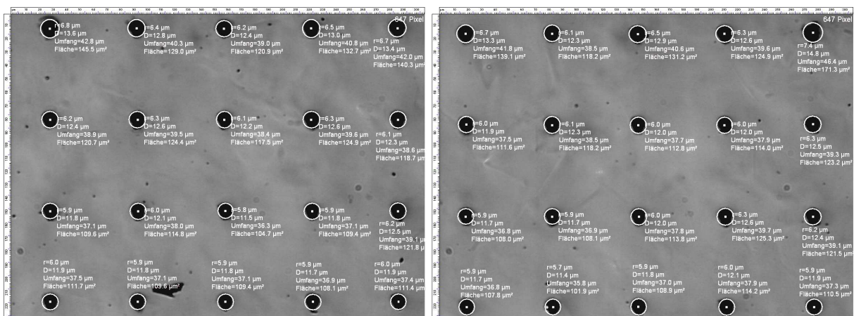
Abb. A.5.: Mikroskopaufnahmen der laserzugewandten Diamantoberfläche. Bestimmt werden die Graphitdurchmesser für die Herstellungsparameter 100 mW mit 20 – 70 \mu\text{m/s} und 80 mW mit 5 \mu\text{m/s} .
