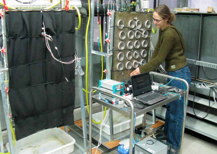
Anlage zur Untersuchung des Wurzelsystems von Pflanzen
