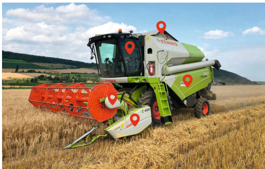
Abb. 2: Durch Augmented Reality lassen sich an den markierten Stellen Zusatzinformationen bei Bedarf abrufen und im Maschinenkontext darstellen. Hiermit werden Störungssuche und Fehlerbehebung im realen Zusammenhang mit der eingesetzten Maschine erleichtert.
