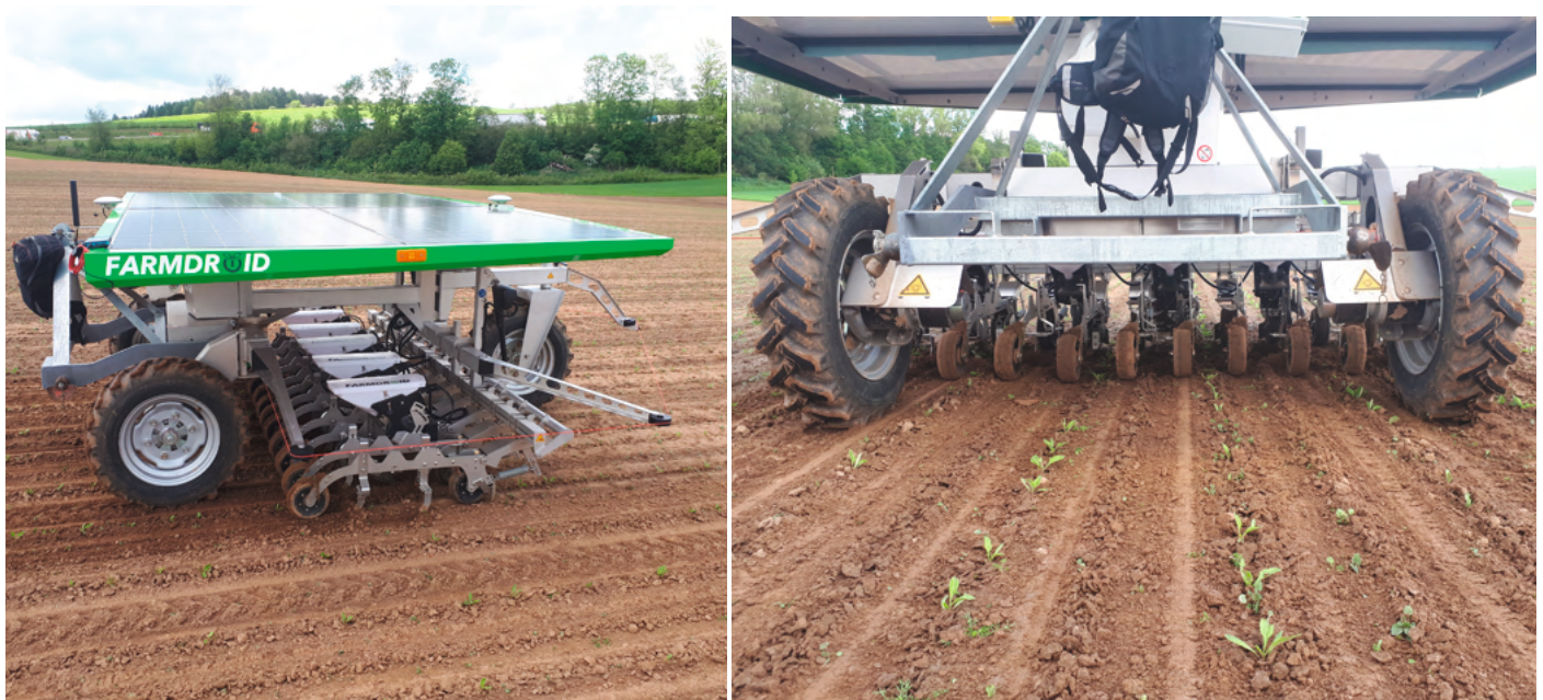
Der autonom fahrende Roboter FarmDroid FD 20 beim Hacken im Zuckerrübenbestand.
